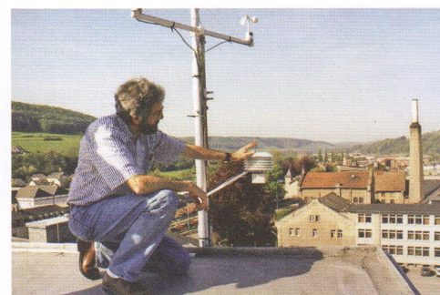
Francis Massen sur le toit de la cabine de l'ascenseur montrant l'équipement qui abrite le thermomètre et l'hygromètre électroniques (1997).
